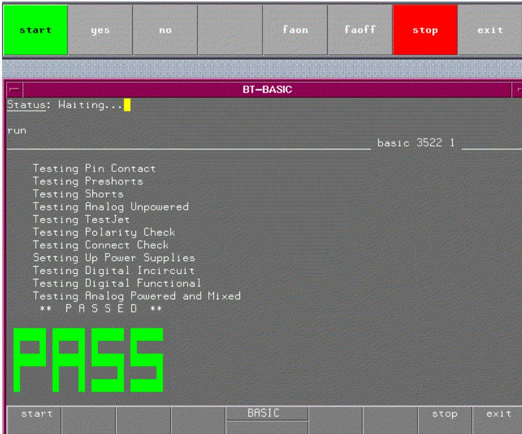
Agilent 3070 的測試主程式是”testplan”,在有 testhead 控制權的 BT-BASIC 視窗,開啓”testplan”
