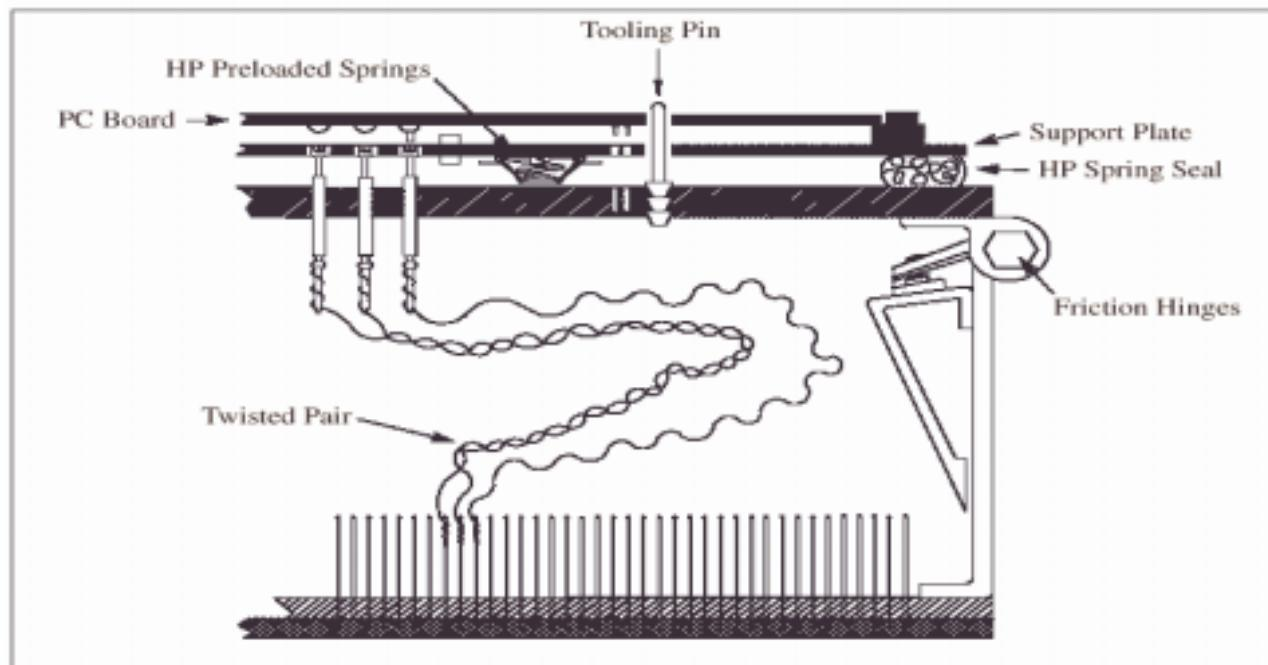
下图为短线夹具的内部结构示意图：（目前 HP 夹具均采用此类型）
