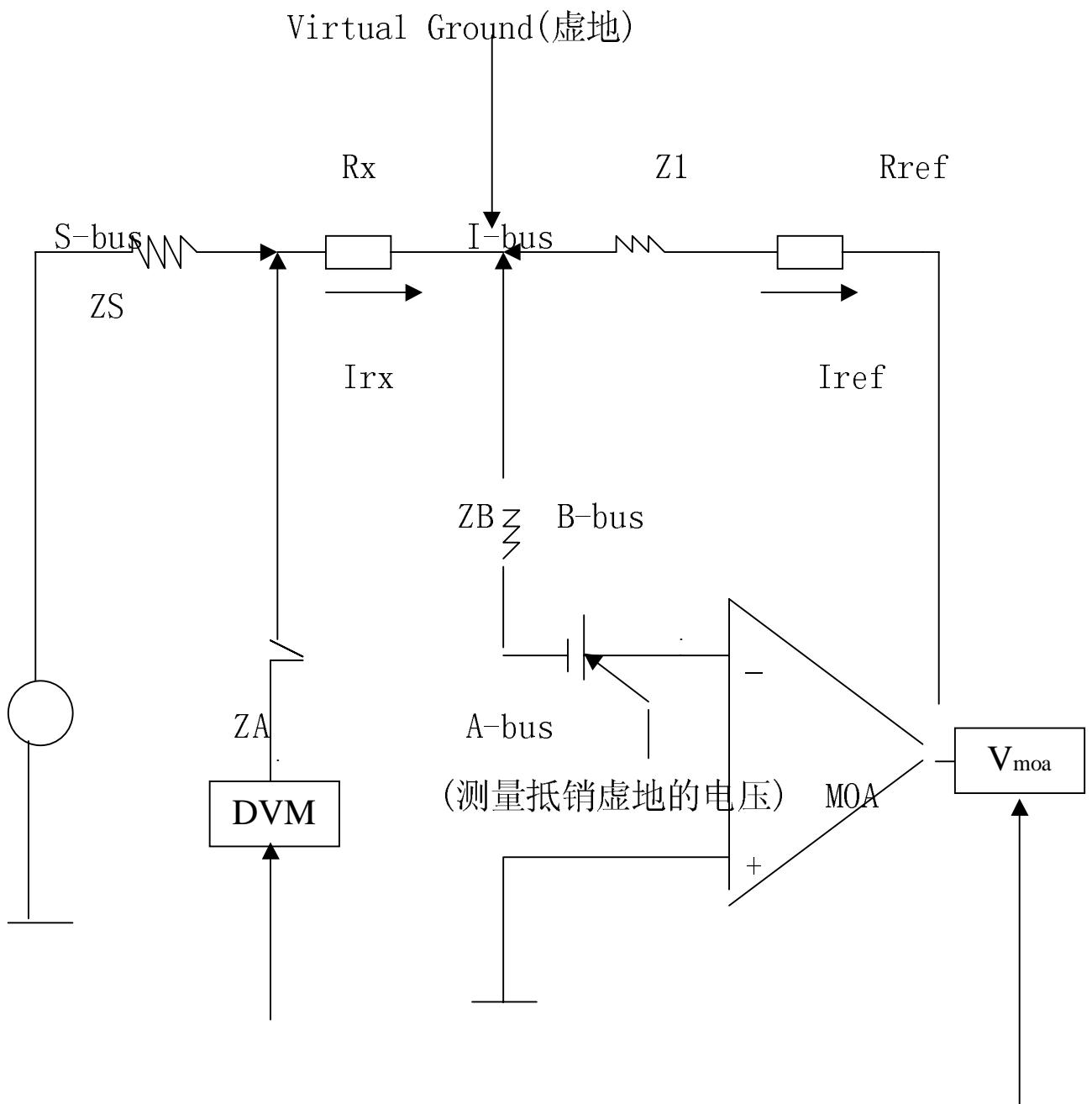
(为了测量 RX 上真正的压降引入一个直流恒压源)      (MOA 输出电压)
