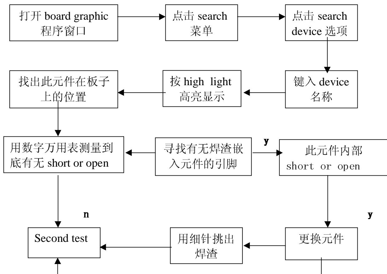
下图为检修 node short or open 的流程图:
